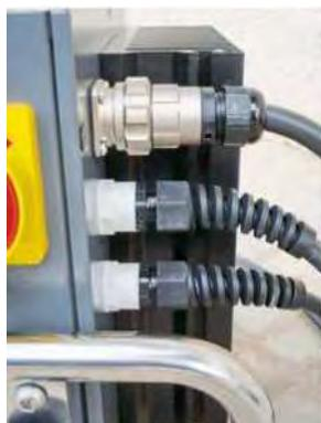
*Рисунок 11a: Сетевой кабель (подключенный)*
